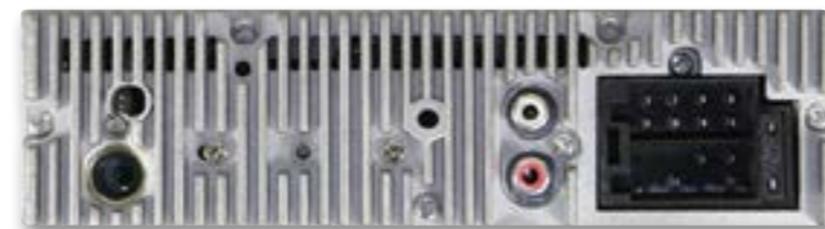
Линейных выходов одна пара, тыловая. Стандартный антенный вход, разъем ISO и предохранитель на 7,5 А
