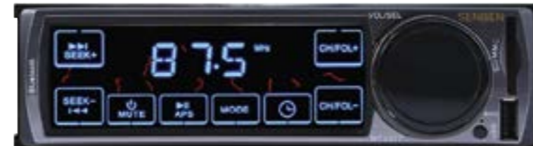
Фронтальная панель несъемная, на фото удалена декоративная рамка. На дисплей выводится режим работы, частота настройки, ячейка памяти программ, текущее время, номер файла
