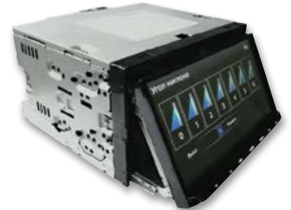
Сенсорный экран с диагональю 7 дюймов и разрешением 800x480 пикселей моторизован, предусмотрено 7 вариантов угла наклона
