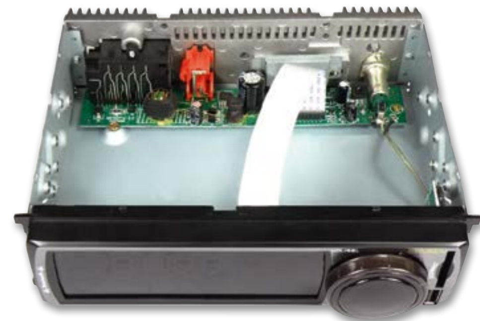
Габариты ресивера стандартные. Плата у задней стенки — это усилитель мощности TDA7388, скромный фильтр питания и целый выводок стабилизаторов напряжения
