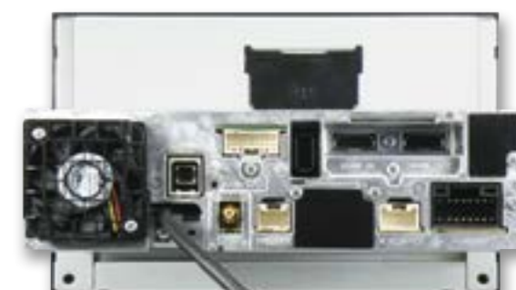
Массивный литой корпус-радиатор дополнен активным охлаждением. Вся задняя панель занята многочисленными разъемами
