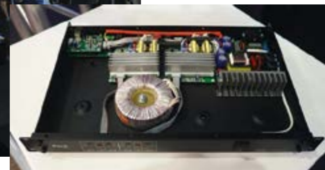
Компоновка инсталляционного усилителя PARK AUDIO TA604
