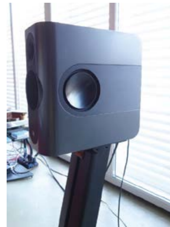
В системе — два симметричных боковых драйвера
