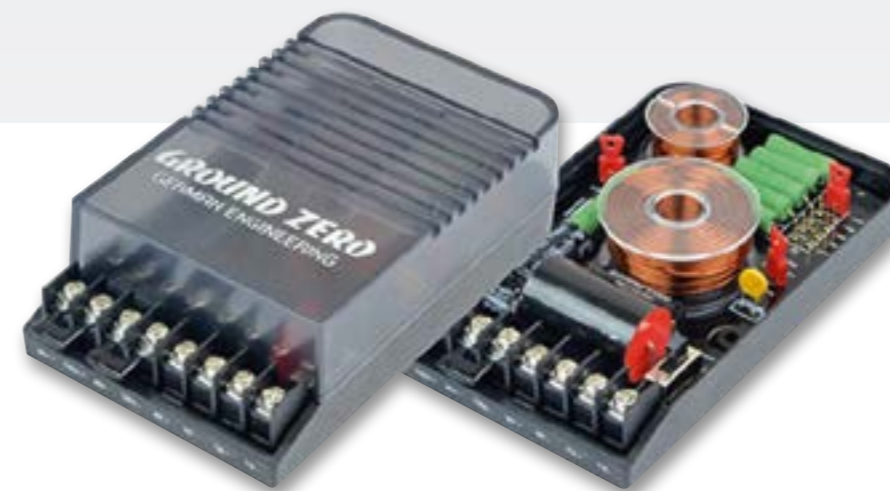
Кроссовер довольно компактный, его габариты 142 x 86 x 43 мм
