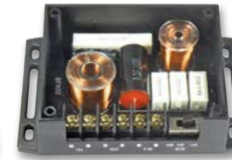
Кроссовер довольно простой конструкции, два фильтра второго порядка и трехпозиционный attenuator для пищалки
