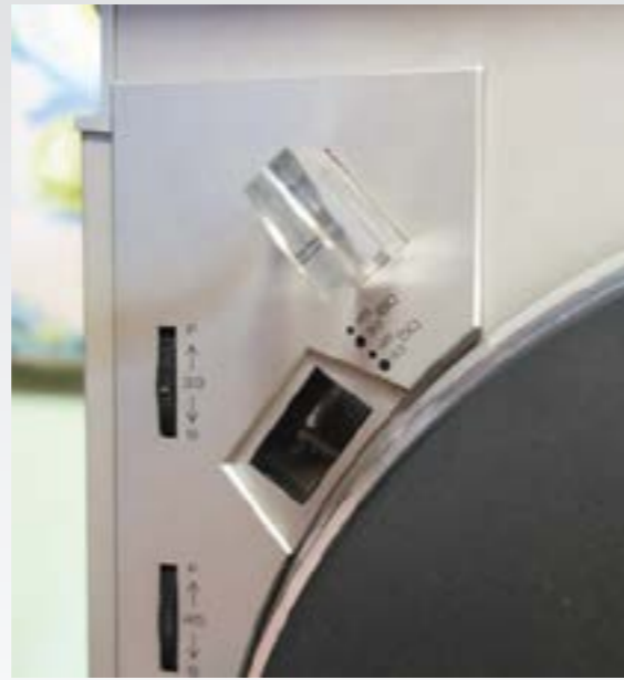
Датчик размера и наличия диска с потенциометрами подстройки скорости
