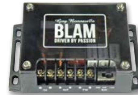
Кроссовер довольно простой конструкции, два фильтра второго порядка и трехпозиционный attenuator для пищалки
