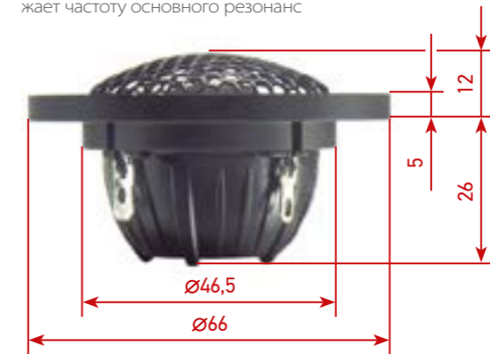
Алюминиевый фланец одновременно является коротким экспоненциальным рупором, поэтому его диаметр заметно больше привычных 40-45 мм
