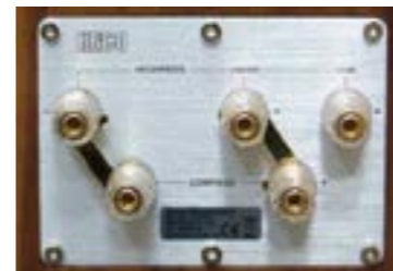
Панель клемм акустического кабеля и заводской шильд
