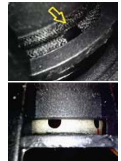
Отверстия в центрирующей шайбе — для снижения жесткости. Иначе не получить столь низкую частоту резонанса при легкой подвижной системе
