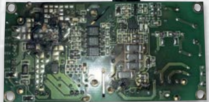
Это блок питания, который когда-то был рассчитан на американскую сеть. Его переделали под наши 220 В, как смогли... Определенное время устройство работало, но потом пошел дым — восстановить устройство уже невозможно, только замена на новое
