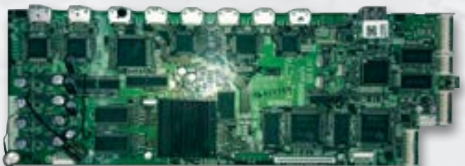
А так плата выглядит после попытки ремонта непонятно кем... Добавлен радиатор на процессор, припаяна куча каких-то деталей. Результат для незадачливого покупателя «серой» продукции: 350 евро за замену платы
