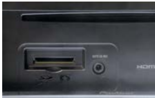
Рядом со слотом SD-карточки находится мини-джек для подключения измерительного микрофона
