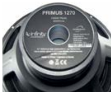
Несмотря на большой ход диффузора, вентиляруемый магнитопровод обошелся без проточки в заднем щите — два магнита и так обеспечивают ему необходимую глубину
