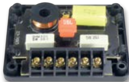
Кроссовер предназначен только для пищалки, но оснащен по расширенной программе
