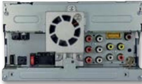
Радиатор усилителей мощности интегрирован с вентилятором охлаждения, набор разъемов почти на все случаи коммутации. Но места на задней панели хватило всем
