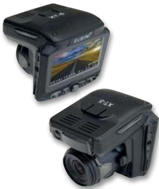
Автомобильный комбинированный видеорегистратор Subini XT-5 является дальнейшим развитием модели STR XT-3. При аналогичном дизайнерском решении в новой модели доработана аппаратная часть, улучшено программное обеспечение. Так, в новинке используется более мощный процессор Novatek 96658, что позволило улучшить разрешение съемки до Full HD и добавить возможность обработки изображения с парковочной камеры. В качестве сенсора используется матрица Sony Imx 323.
