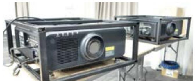
Сшивка изображений проводилась на базе двух инсталляционных проекторов PT-RZ970WE
