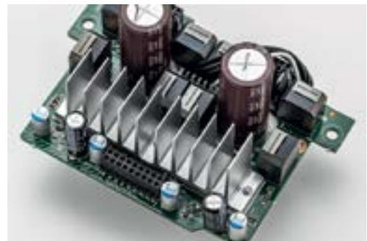
Модуль усилителя мощности
