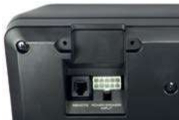
При таких габаритах корпуса для регуляторов места не нашлось, на нижней стенке лишь два компактных разъема
