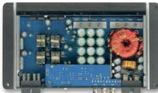
Впечатление «пустоты» обманчиво: все мощные компоненты находятся с обратной стороны платы
