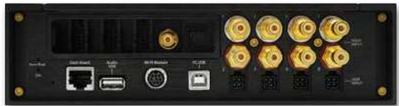
Панель входной коммутации
