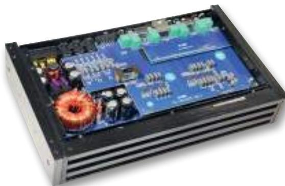
Усилитель собран в два «этажа». Предохранители — внутри корпуса. Блок питания расположен достаточно близко к слаботочной аналоговой части. К счастью, никаких проблем с помехозащищенностью это не вызвало и на общем уровне шумов не отразилось
