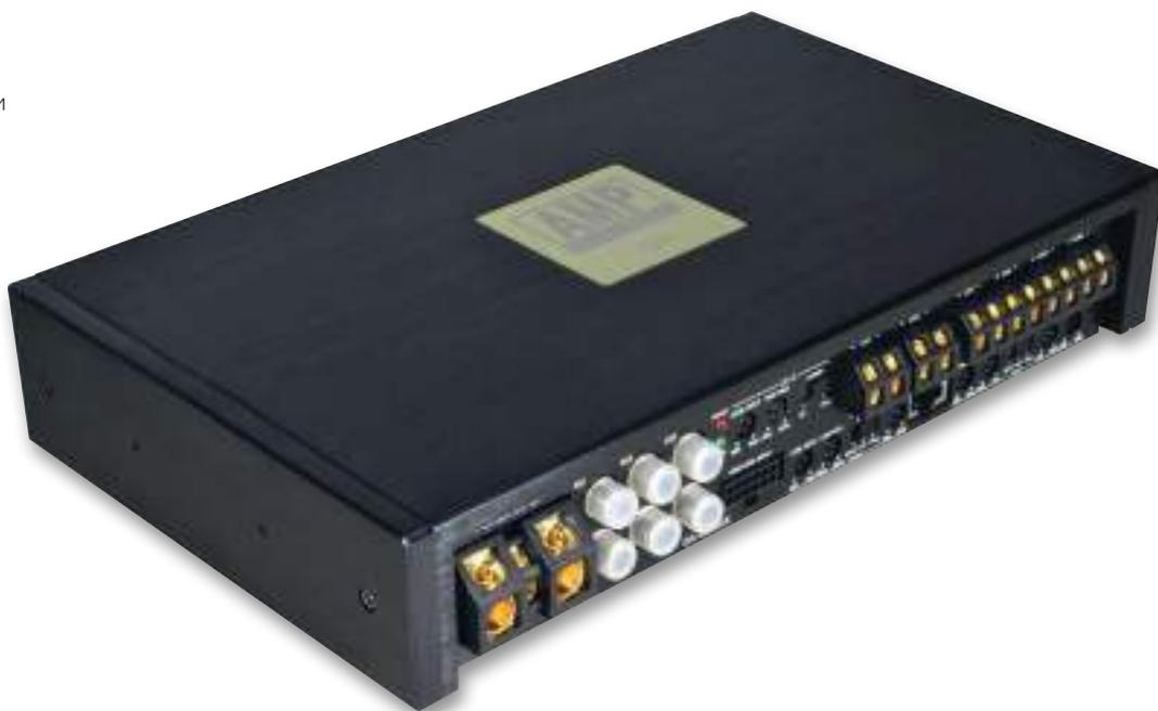
**Этот усилитель — слегка упрощенная версия усилителя PANACEA: вместо процессора применен классический аналоговый кроссовер, а усилитель мощности остался без изменений. Это отличное решение и для приверженцев аналоговых методов обработки сигнала, и для тех, у кого уже есть процессор — отдельный, или в составе головного устройства.**
