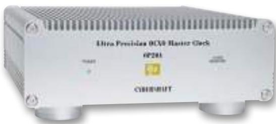
Cybershaft OCXO Type 3 — новый тактовый генератор, который подойдет для широкого спектра цифроаналоговых преобразователей и существенно улучшит их звучание. Аппарат имеет четыре выхода, каждый из которых может снабжать систему точным 10 МГц осцилляционным сигналом. Часы используют линейный регулятор LT3045 и блок питания высокой линейности PSRR. OCXO Type 3 допускает выходные уровни в 1.6V p-p и 3.0V p-p, его выходное сопротивление равно 50 или 75 Ом. Весит аппарат 3,8 кг.
