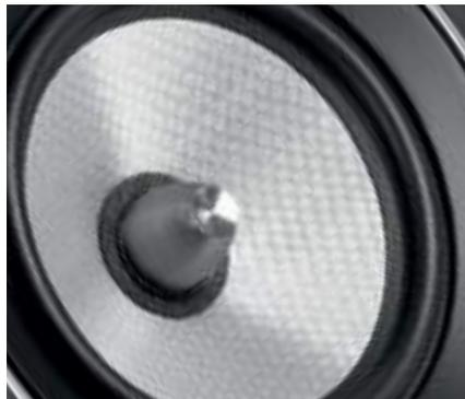
Для большей жесткости композитный диффузор армирован крупноячеистыми элементами
