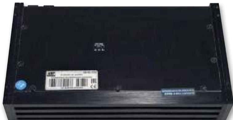
Днище стальное, опломбированное, радиатор — символический На днище усилителя находится переключатель конфигурации входов (2/4/6)
