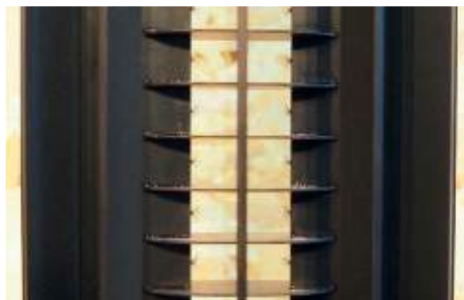
Фрагмент панели с иридиевыми игольчатыми электродами
