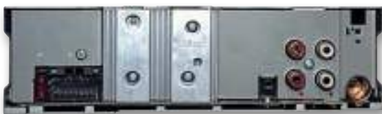
«Кормовой отсек» оснащен двумя парами линейных выходов, входом для микрофона Hands Free, разъемом антенны и колодкой для хвостика-переходника ISO, входящего в комплект
