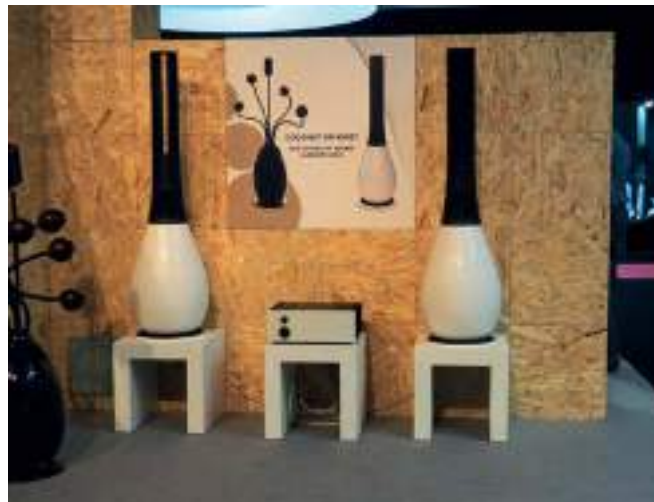
Прототип стереокomплекта с ионными излучателями СЧ/ВЧ от Sorra
