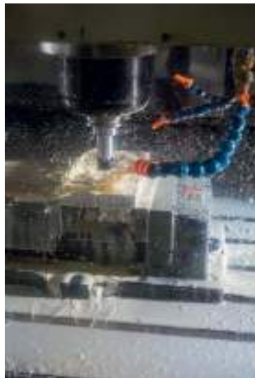
Металлические части изготавливаются на станках с ЧПУ
