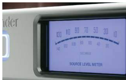
На трехдюймовый AMOLED-дисплей выводится уровень громкости в «аналоговом» представлении в виде стрелки прибора
