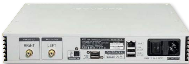
Разъемов для подключения на задней панели немного: Ethernet-вход, два USB-порта, оптический S/PDIF. Предусмотрено два выхода: аналоговый RCA и асинхронный USB-порт
