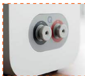
В нижній частині задньої стінки корпусу розмістилась пара гвинтових акустичних терміналів
