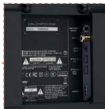
Усі фізичні роз'єми захищені в ніші на задній панелі корпусу. Скористатися ними доведеться тільки при установці саундбара
