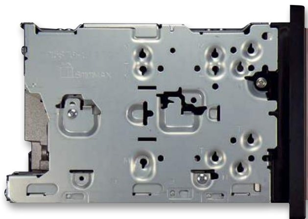
Профиль уже привычный: применен стандартный двухдюймовый корпус. Корма внизу немного выступает за габарит, там основная плата
