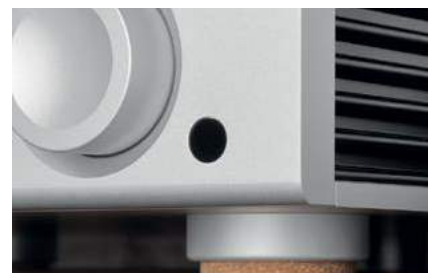
Для повышения виброизоляции основание ножек аппарата сделано из цельного куска пробки, который привинчен к каждой ножке
