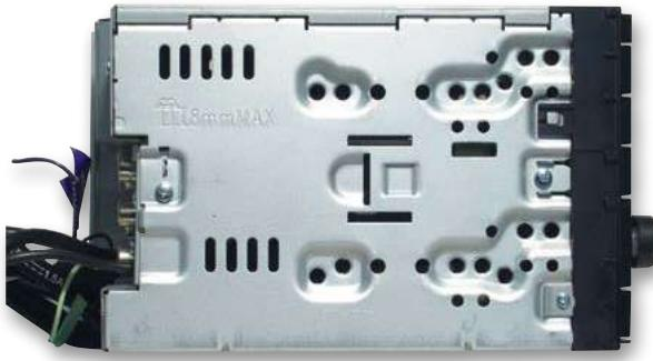
Несмотря на отсутствие дисковода, глубина корпуса осталась прежней
