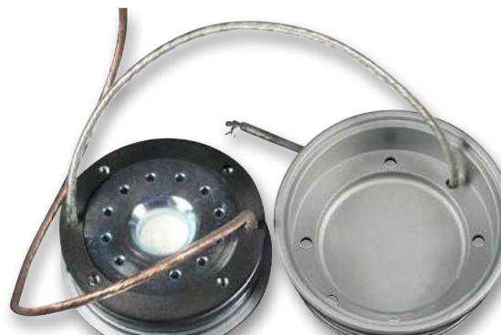
Съемная тыловая камера опускает частоту резонанса ниже 800 Гц, для выравнивания давления под куполом и в камере служат 12 отверстий в заднем щите магнитопровода
