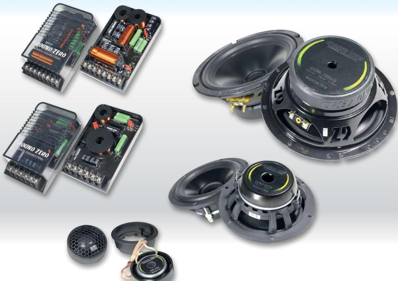
размер 80 мм, это чуть больше стандартного 3-дюймового калибра. Внешний диаметр фланца — 94 мм, диаметр посадочного отверстия — 77 мм. Корзины — пластиковые. Жесткость достаточная. Моторы — с кольцевыми неодимовыми магнитами. Посадочная глубина — всего 34 мм. Вентиляция катушек организована через осевые отверстия и окна под центрирующими шайбами.
