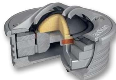
размещенный под куполом демпфер из пористого материала и вкладыш из плотного войлока в отверстии магнитопровода минимизируют резонансы и обеспечивают гладкую АЧХ во всем диапазоне рабочих частот (по материалам Audison)
