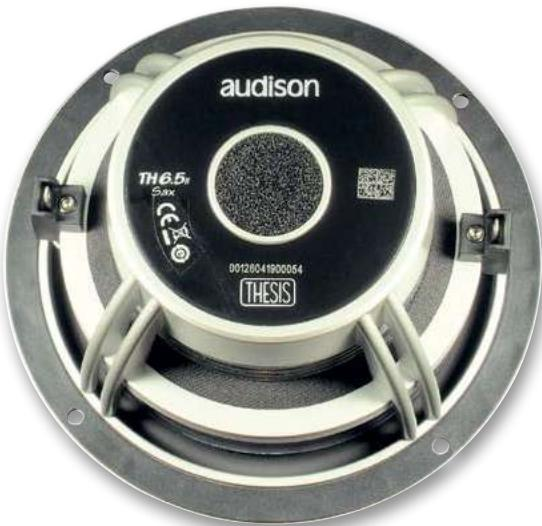
Диффузородержатель из алюминиевого сплава с четырьмя парами спиц обеспечивает прочность и жесткость, не препятствуя движению воздуха
