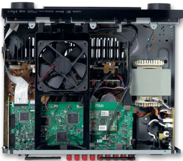
Ресивер побудований на потужній обчислювальній платформі, що базується на чотирьохъядерному 32-бітному процесорі від Cirrus Logic, який працює спільно з DSP Aureus від Texas Instruments
