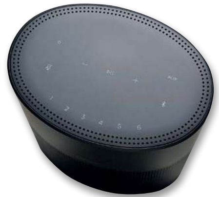
Панель управління серед іншого містить кнопку відключення мікрофонів, а також шість кнопок швидкого доступу
