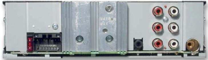
Аппарат оснащен тремя парами линейных выходов с напряжением 5 В
