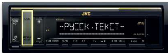
Порт USB и вход AUX закрыты откидной шторкой, вставка «под золото» в верхней части панели завершает композицию
