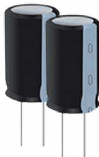
Суперконденсатори запобігають пошкодженню файлів у разі зникнення живлення
