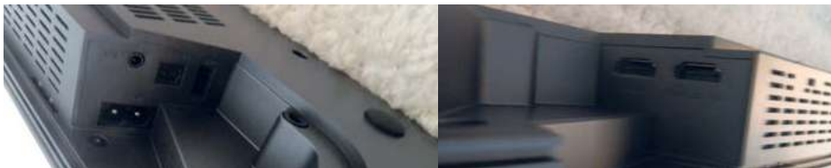
Комутаційний арсенал досить скромний — вхід HDMI 2.0 для консолі чи програвача Ultra HD Blu-ray, HDMI-ARC для підключення до телевізора, оптичний вхід та порт USB
