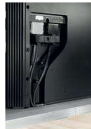
Підставка з'єднується з телевізором спеціальним шлейфом
