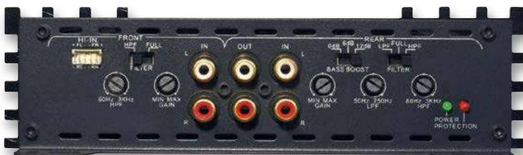
На другом торце находятся две пары входов и пара линейных выходов без обработки сигнала. В уголке — разъем входов высокого уровня
