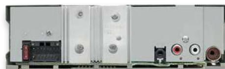
Аппарат оснащен одной парой переключаемых линейных выходов (тыл/сабвуфер). Рядом — вход для стандартного выносного микрофона, входящего в комплект...
