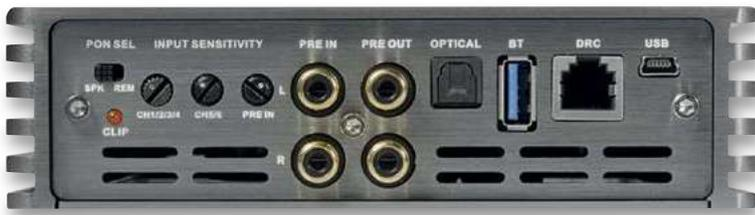
С одной стороны корпуса расположены регуляторы чувствительности пар каналов, переключатель выбора режимов включения, линейный вход и линейный выход, оптический S/PDIF
