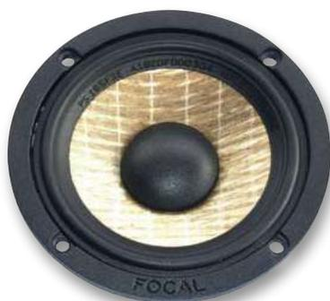
Диффузор среднечастотника той же конструкции, что и у мидбаса, но, разумеется, меньшей толщины и диаметра
