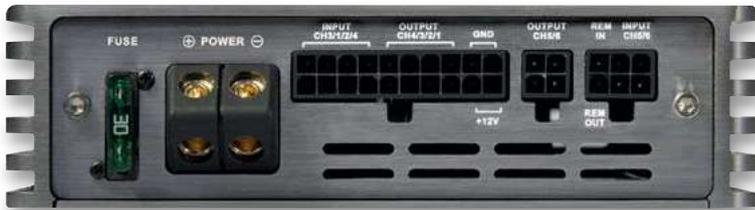
С противоположной стороны расположен предохранитель и силовые разъемы питания
