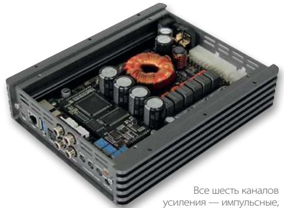
Все шесть каналов усиления — импульсные, выполнены на современной элементной базе
