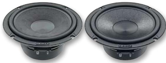
Диффузор С 165 L изготовлен из непрессованной целлюлозы, у С 165 он выполнен из прессованной смеси целлюлозы с наполнителем из слюды
