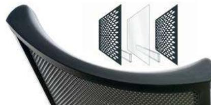
Конструкція електростатичного випромінювача: між двома пластинами з перфорованого металу натягується тонка мембрана. Під час подачі напруги на пластини між ними і мембраною виникає електростатична взаємодія
