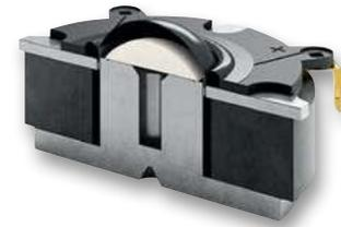
Благодаря легкости диффузора мягкокупольного твитера существенно расширена область воспроизведения самых высоких частот. А увеличенный диаметр диффузора и звуковой катушки повышает чувствительность и максимально допустимую мощность, снижает искажения и позволяет динамике воспроизводить более низкие частоты
