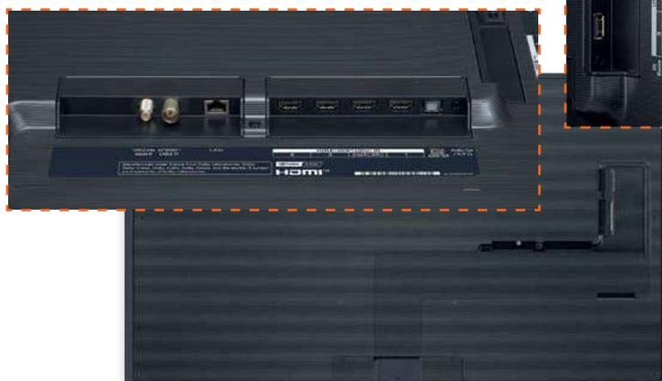
На задній панелі розташовані чотири входи HDMI v2.1 (один з яких сумісний з ARC і eARC), два антенні входи (для супутникового і кабельного/ефірного ТБ), один порт LAN (зі швидкістю 100 Мбіт/с), оптичний аудіовихід і вихід 3,5" на навушники/ акустику
