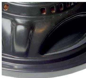
Развитый рельеф четырех спиц и П-образный профиль фланца обеспечивают необходимую жесткость диффузородержателя
