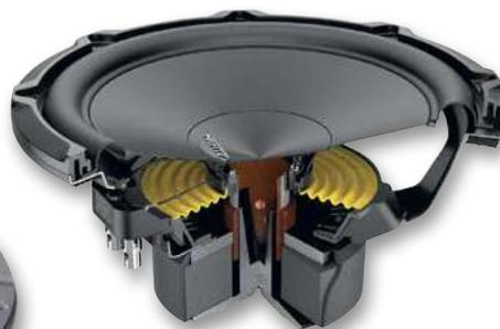
Магнитная система отличается рядом инноваций — глухое коническое отверстие в керне фокусирует магнитное поле в зазоре. Керн магнитной системы выступает за передний магнитопровод, это симметрирует магнитное поле в окрестностях магнитного зазора и способствует снижению четных гармоник
