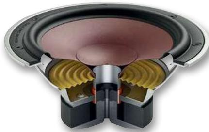
Диффузоры СЧ/НЧ-динамиков выполнены из фирменного материала — смеси тонкой бумажной пульпы и древесных волокон, позволяющего создать жесткую, легкую и хорошо управляемую структуру. Звуковая катушка выполнена из алюминиевой проволоки с медным покрытием. Технология мягкого магнитного композита SMC позволяет существенно снизить механические искажения. Диффузор покоится на резиновом подвесе, что обеспечивает свободный ход при крайне низком демпфирующем эффекте
