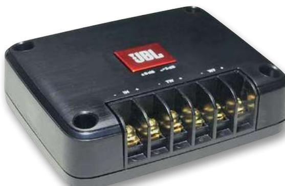
Кроссовер второго порядка с частотой среза 5,5 кГц предназначен только для пищалки
