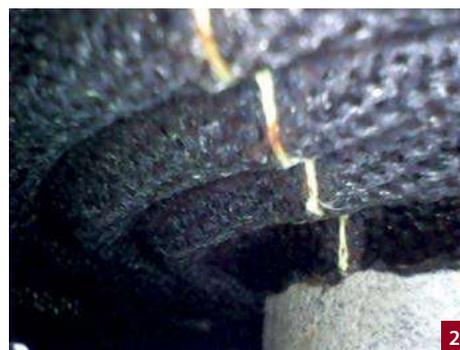
В нижней части кадра видны крайние витки звуковой катушки, в верхней — фрагмент центрирующей шайбы
