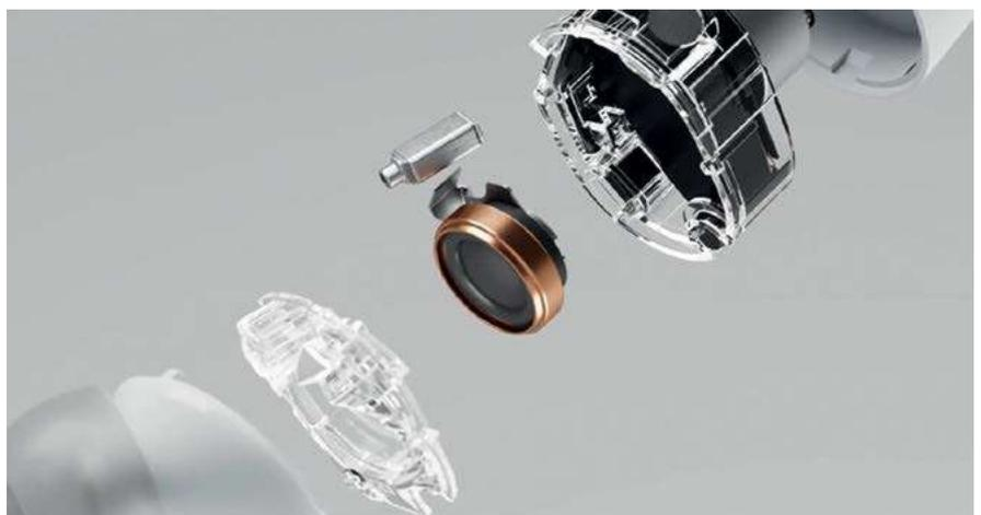
В B&W PI7 використовується гібридна конфігурація випромінювачів — разом з динамічним драйвером тут у кожному вкладиші встановлений також арматурний. Пристрій одержав систему з двох випромінювачів: 9,2-міліметрового для середніх і низьких частот, а також для високих частот. Кожен навушник оснащений роздільними підсилювачами для кожного випромінювача, що дозволило оптимізувати їх роботу
