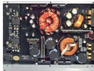
Значительную часть объема корпуса занимают конденсаторы в цепях питания
