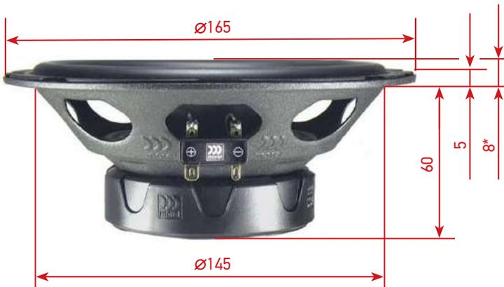
Размеры мидбасовой головки, включая посадочную глубину, стандартные
