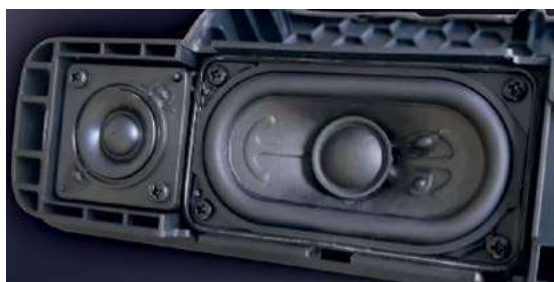
На фронтальній панелі (вигляд зліва) — середньочастотник з твітером. Така ж сама пара — з правого боку
