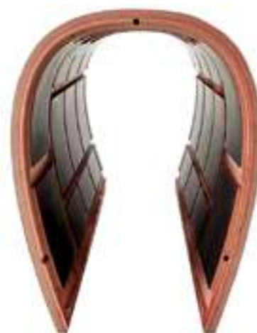
В поздовжньому розрізі корпус має форму краплі
