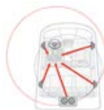
Розбіжність надходження звукових сигналів до слухача корегується за допомогою функції DTA
