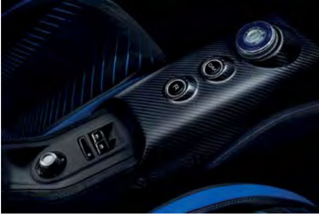
Поряд із звичними елементами керування вікнами (закрити/відкрити) та дзеркалами на дверях додатково розташовані функції медіасистеми та режими швидкості
