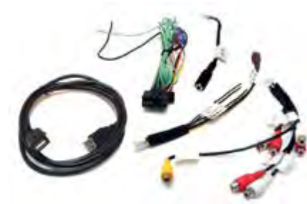
На проводах вынесены три пары линейных выходов, вход камеры заднего обзора, вход внешних AV-источников AUX, видеовыход для дополнительного монитора. Разъем питания и акустики оканчивается проводами. Если понадобится соединитель ISO, его придется смонтировать самостоятельно
