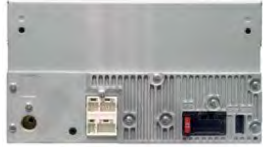
Вся коммутация вынесена на жгуты с разъемами, поэтому задняя панель почти плоская. Порт USB также снабжен удлинителем
