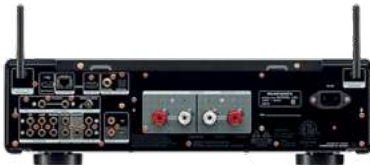
Повний вигляд задньої панелі, включаючи антени Wi-Fi і Bluetooth
