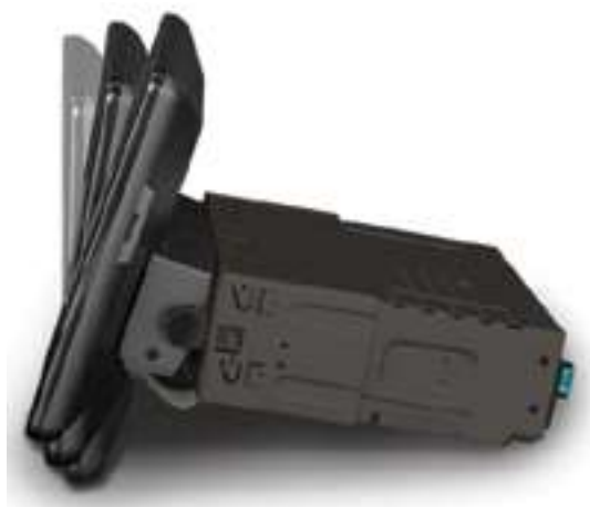
Панель дисплея має кут нахилу та відносно регулювання висоти для оптимального положення в салоні автомобіля (Зображення: Zenec)
